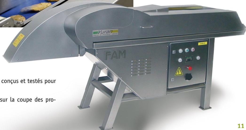
La **FAM Yuran** coupe la viande fraîche et demi-congelée avec un minimum de pertes. Le réglage, le nettoyage et la maintenance de la coupeuse sont simples.
